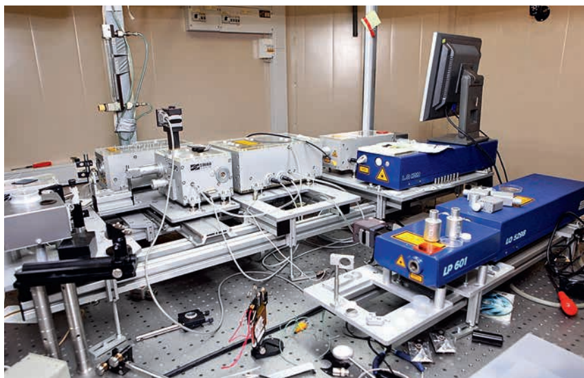
Стенд наносекундной спектроскопии на базе оптического параметрического осциллятора «Солар».
