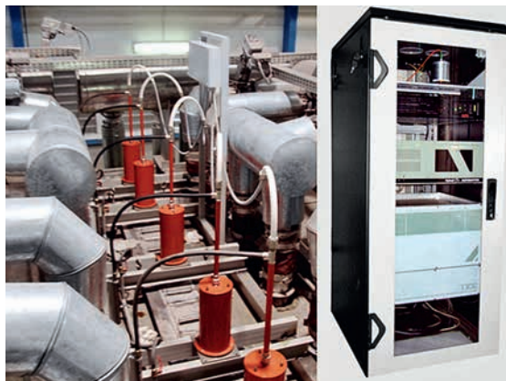
Основной блок системы измерения толщины стекла in situ и оптические головки, установленные на своде печи отжига.
