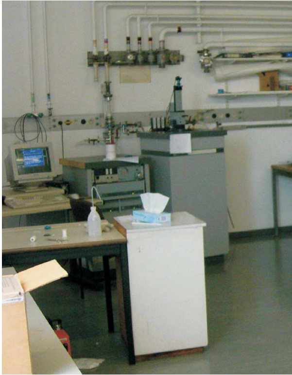
Рис. 26: Общий вид установки MPMS (magnetic properties measurement system) компании Quantum Design с возможностью охлаждения образцов до 1.6 К и создания магнитного поля до 5 Т (слева) и установки для проведения низкотемпературных магниторезистивных измерений при температурах от 0.4 К на основе криостата Heliox Oxford Instruments, оснащённого сорбционным насосом для ^3\text{He} и соленоидом для создания магнитного поля до 7 Т (справа) в Лаборатории физики твёрдого тела и магнетизма Католического университета Лёвена (К. У. Leuven, Бельгия). На этих установках были проведены все магнитные и транспортные измерения для планарных гибридных структур CoPd/Nb/CoPd, Al/CoPt, Al/BaFe 12 O 19 и Pb/BaFe 12 O 19 , описанные в главах 2, 3 и 4.
