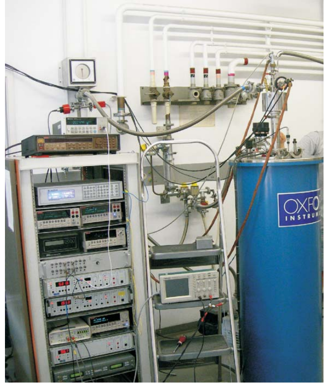
Рис. 26: Общий вид установки MPMS (magnetic properties measurement system) компании Quantum Design с возможностью охлаждения образцов до 1.6 К и создания магнитного поля до 5 Т (слева) и установки для проведения низкотемпературных магниторезистивных измерений при температурах от 0.4 К на основе криостата Heliox Oxford Instruments, оснащённого сорбционным насосом для ^3\text{He} и соленоидом для создания магнитного поля до 7 Т (справа) в Лаборатории физики твёрдого тела и магнетизма Католического университета Лёвена (К. У. Leuven, Бельгия). На этих установках были проведены все магнитные и транспортные измерения для планарных гибридных структур CoPd/Nb/CoPd, Al/CoPt, Al/BaFe 12 O 19 и Pb/BaFe 12 O 19 , описанные в главах 2, 3 и 4.
