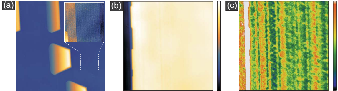
Рис. 144: (a) Топографическое изображение нескольких Рb островков на вицинальной поверхности Si(557) (размер кадра 928 \times 928 \text{ нм}^2 , V_0 = -1.5 \text{ В} и \langle I \rangle = 20 \text{ пА} ). Выравнивание сделано поверхности Si(557), на вставку показан участок поверхности размером 185 \times 185 \text{ нм}^2 , ширина ступеней порядка 4.9 нм. (b, c) Топографическое изображение участка поверхности и карта дифференциальной туннельной проводимости dI/dV для Рb островка на вицинальной поверхности Si(557) (размер кадра 58 \times 58 \text{ нм}^2 , V_0 = +0.6 \text{ В} и \langle I \rangle = 400 \text{ пА} ). Участки красного и зеленого цветов соответствуют локальным максимумам и минимумам дифференциальной проводимости. STM/STS-измерения и обработка результатов: А. Ю. Аладышкин и А. В. Путилов.
