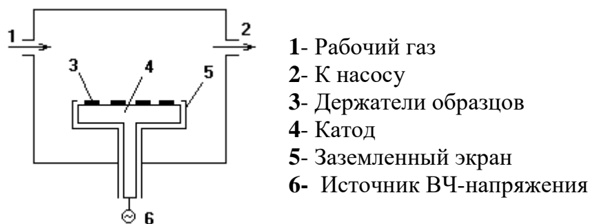
Рис. 1.14. Высокочастотная диодная система для реактивного ионного травления. Рисунок взят из [35].
