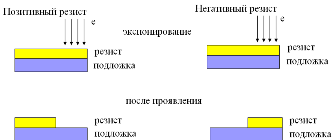
Рис. 1.7. Позитивный и негативный резисты.
