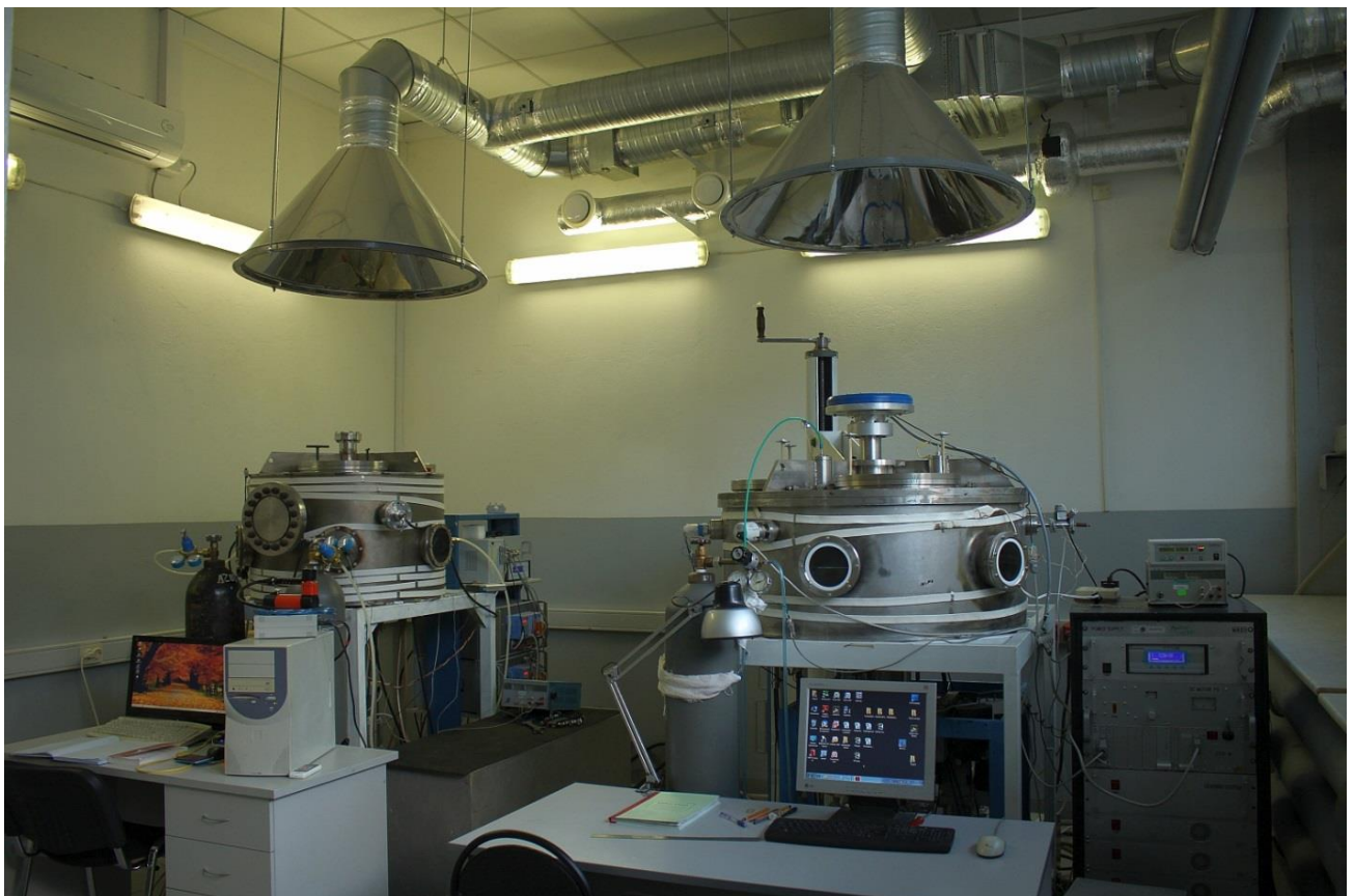
Рис. 4.2. Четырехмагнетронная (слева) и шестимагнетронная (справа) напылительные установки.
