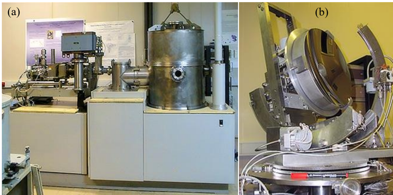
Рис. 4.5. (а) – рефлектометрический стенд для диапазона длин волн 0.6–50 нм, (б) – пятиосный гониометр в камере рефлектометра.
