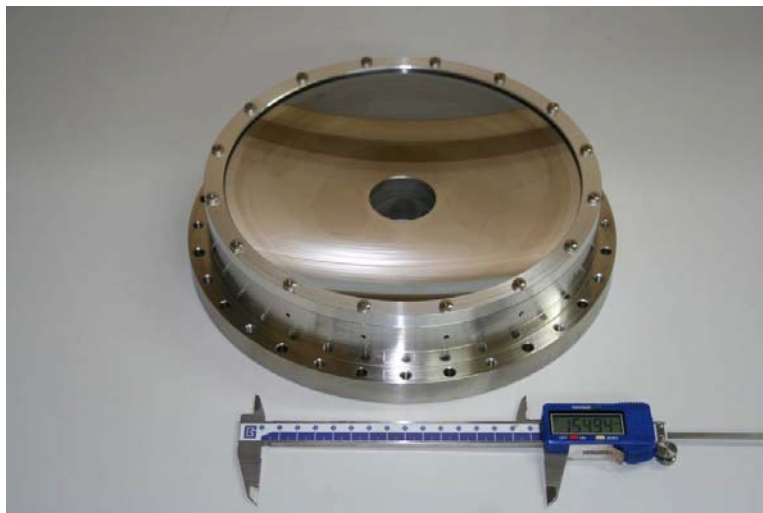
Рисунок 15 - Фотография асферического зеркала нанолитографа M2, клеенного в металлическую оправу.
