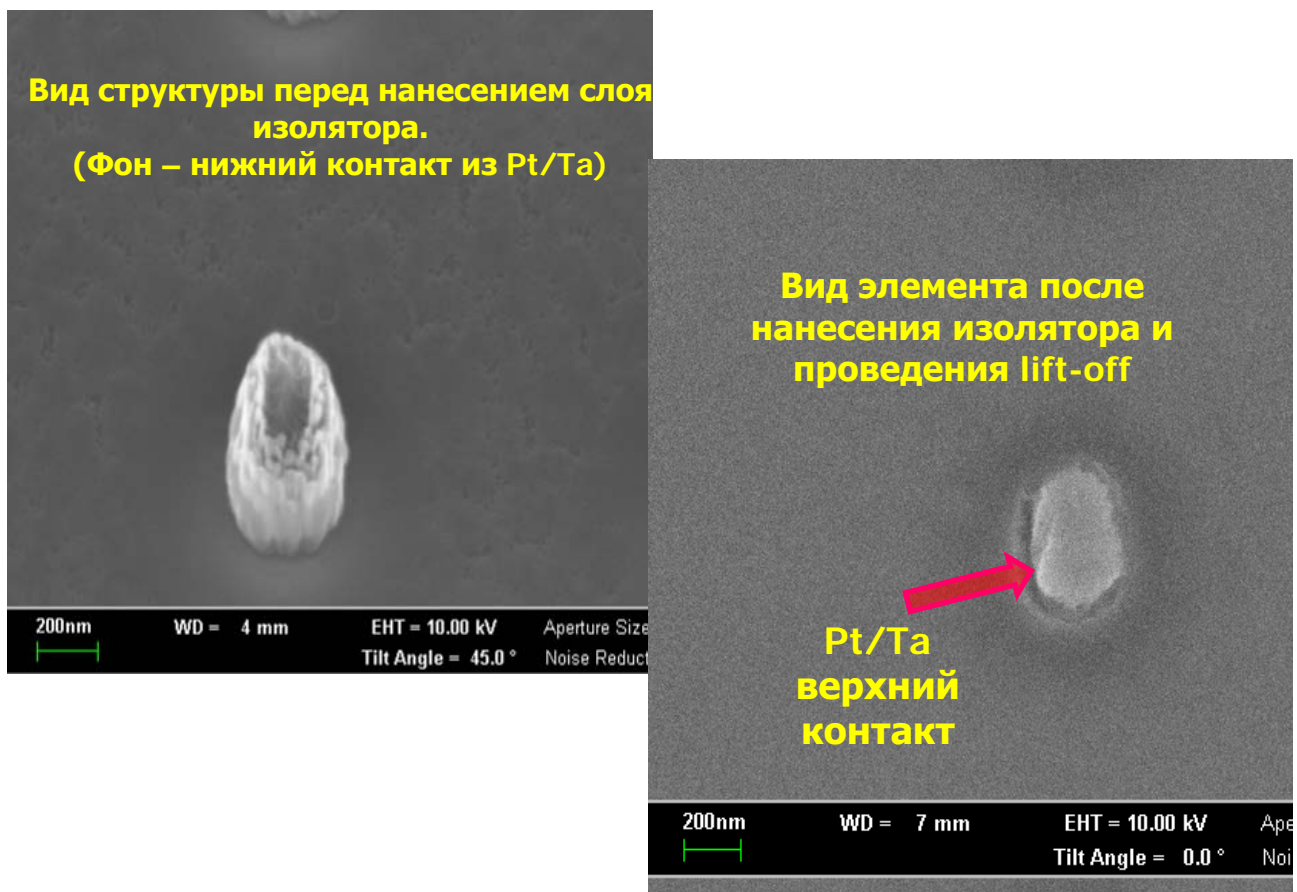
Рисунок 30 - Изображение формируемой частицы во вторичных электронах до нанесения слоя диэлектрика и после его удаления с поверхности частиц.
