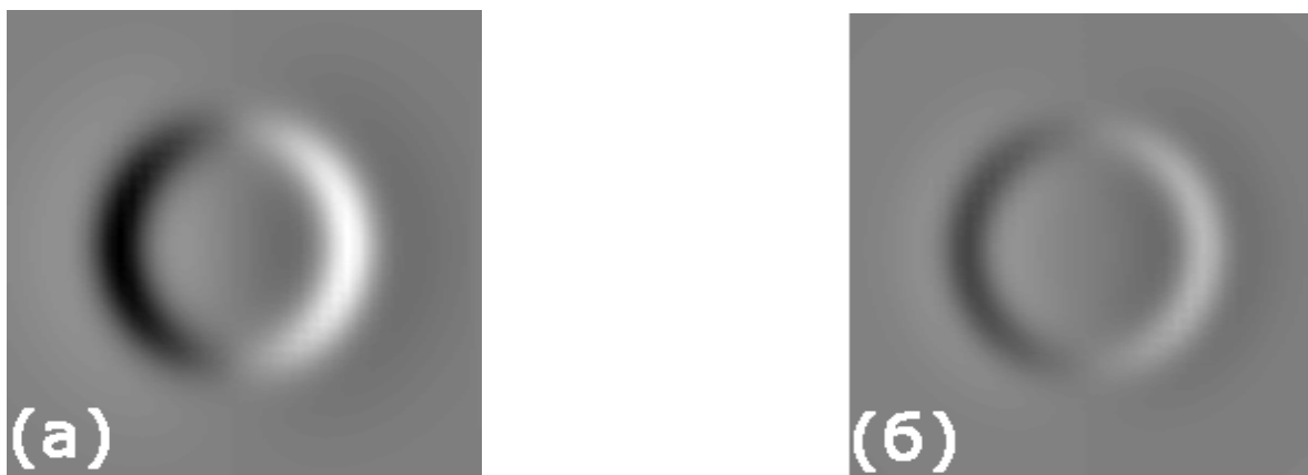
Рисунок 2 - Теоретически рассчитанные МСМ изображения двухслойной частицы CoFe (а) - направление магнитных моментов в слоях совпадают; (б) – магнитные моменты направлены противоположно. (Диаметр частицы 300 нм, толщина слоев CoFe 15 нм, толщина прослойки 3 нм, высота прохода МСМ зонда над верхней гранью частицы 50 нм).
