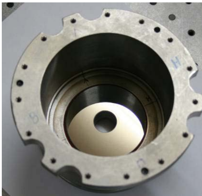
Рисунок 1. Фотография выпуклого асферического зеркала М1 в оправе для проекционного объектива нанолитографа.
