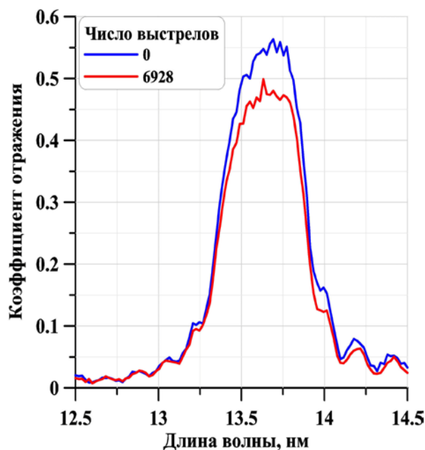
Рисунок 27. Спектральная зависимость коэффициентов отражения Mo/Si многослойного зеркала. Верхняя кривая соответствует закрытой области, нижняя - открытой (подвергнутой загрязнению).
