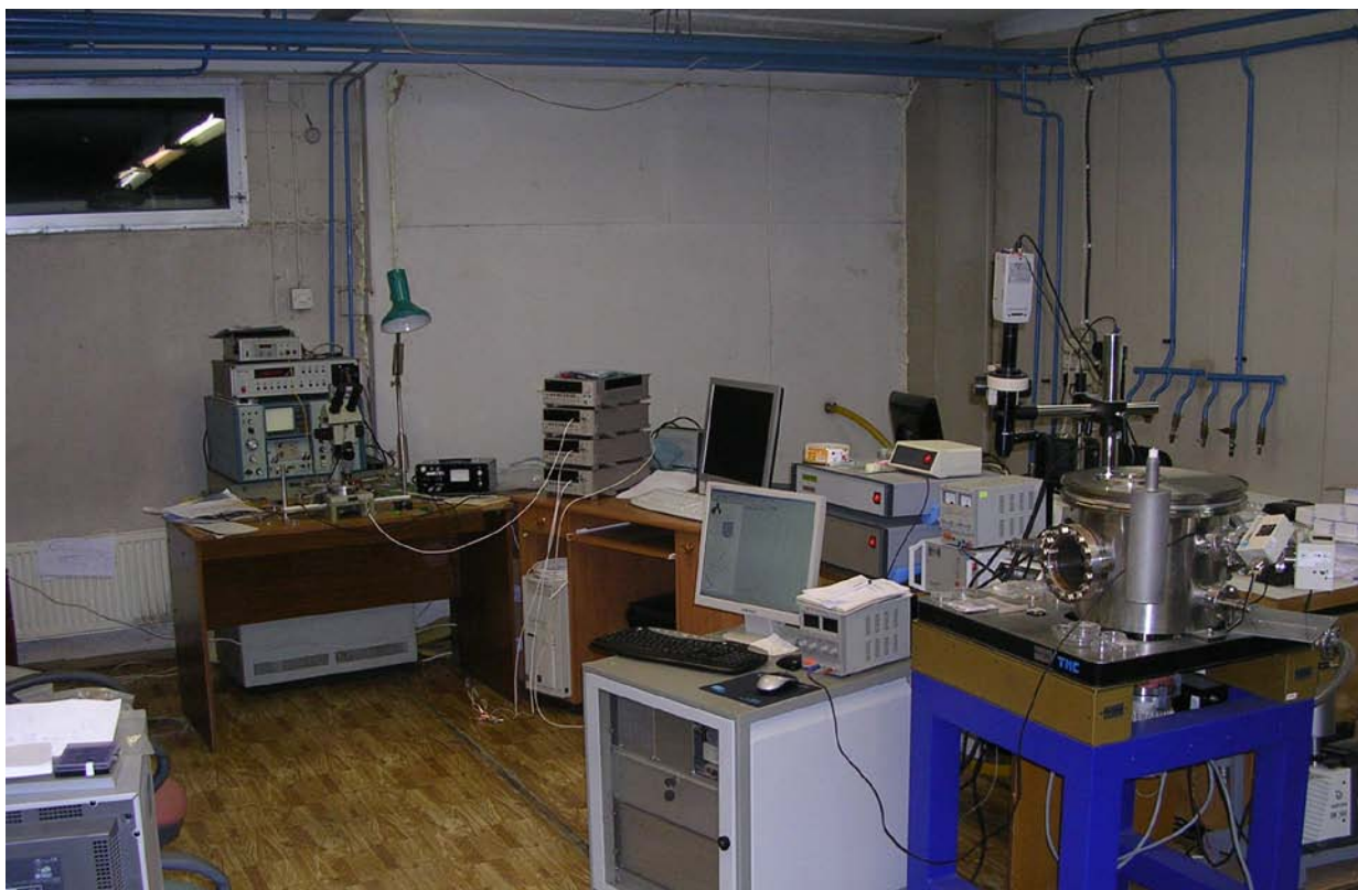
Рисунок 1. Общий вид измерительного стенда и вакуумного магнитосилового микроскопа Solver (НТ-МДТ, Зеленоград)
