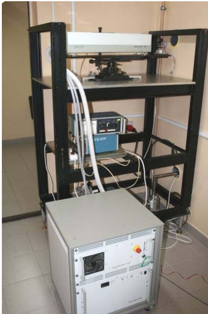
Рисунок 23. Фотография стойки с лазером, светоделительной пластинкой, электро-механической заслонкой, измерителем мощности лазерного излучения и системой питания и охлаждения лазера.
