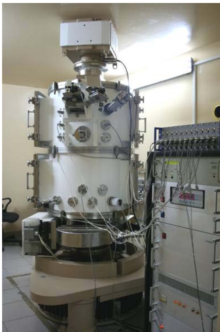
Рисунок 17. Фотография станда нанолитографа с лазерно-плазменным источником ЭУФ излучения.
