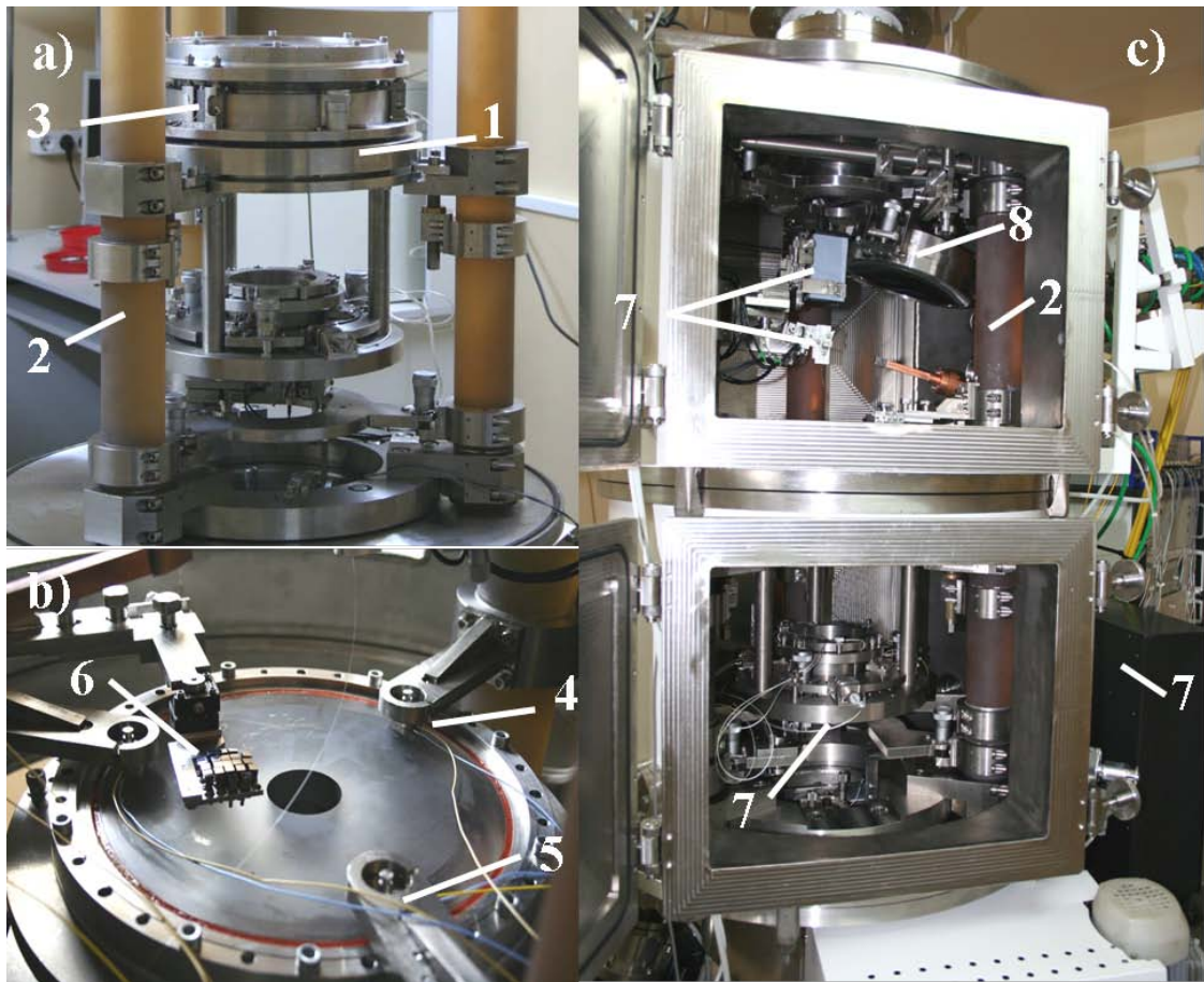
Рисунок 6. Фотография основных элементов нанолитографа с интерферометрической насадкой для аттестации aberrаций объектива. 1 – проекционный объектив, 2 – ситалловые колонны, 3 – пьезо-толкатели, 4 – емкостные датчики положения, 5 – инваровые держатели датчиков, 6 – составное зеркало-осветитель, 7 – интерферометрическая насадка для настройки объектива в нанолитографе, 8 – зеркало-коллектор.
