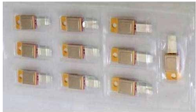
Рисунок 2 - Вид экспериментальных образцов силовых p-i-n диодов
