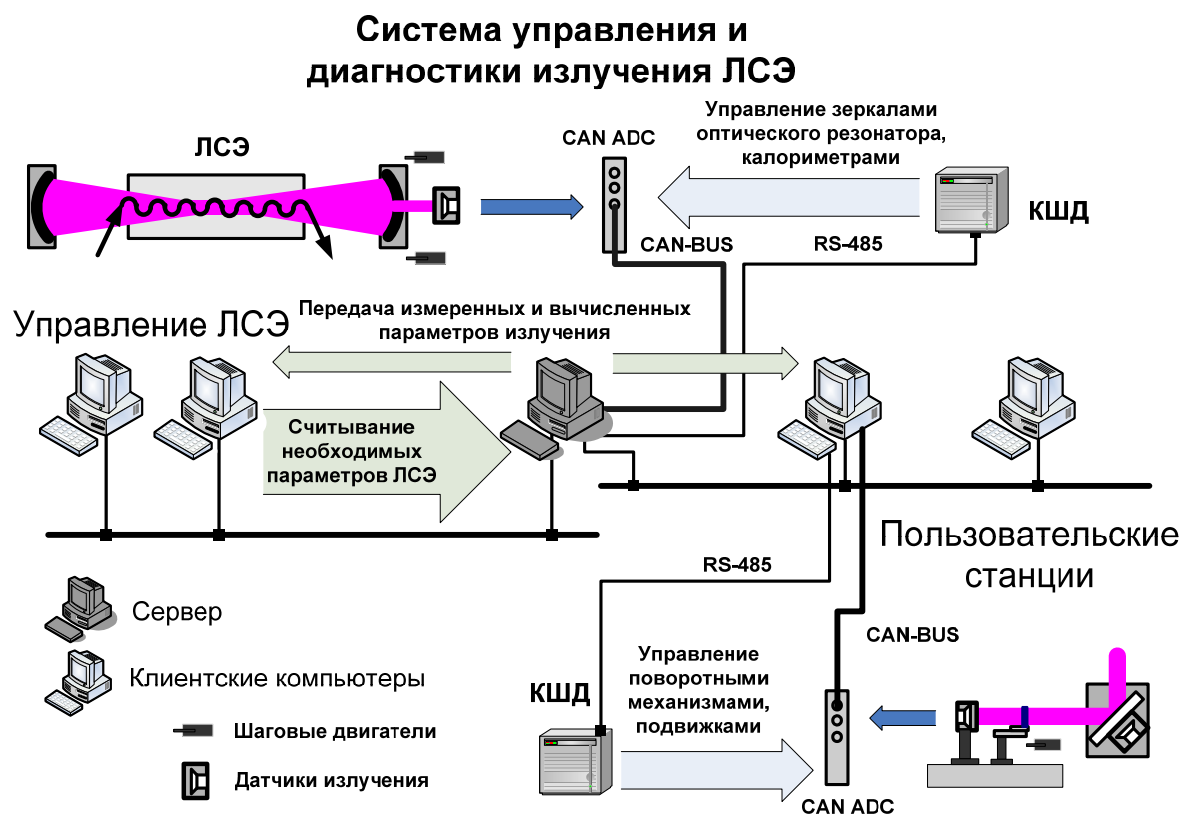
Рисунок 7 – Общая схема системы управления характеристиками излучения ЛСЭ и передачи данных
