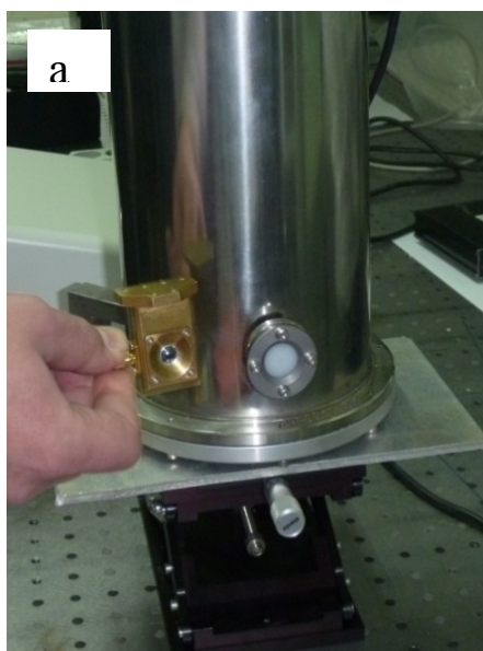
Рисунок 18 – (а) – Общий вид болометра на горячих электронах (рядом показан находящийся внутри него чувствительный элемент с гиперполусферической кремниевой линзой на входе); (б) – Сигнал, соответствующий одному импульсу ЛСЭ, записанный с выхода теплого усилителя болометра
