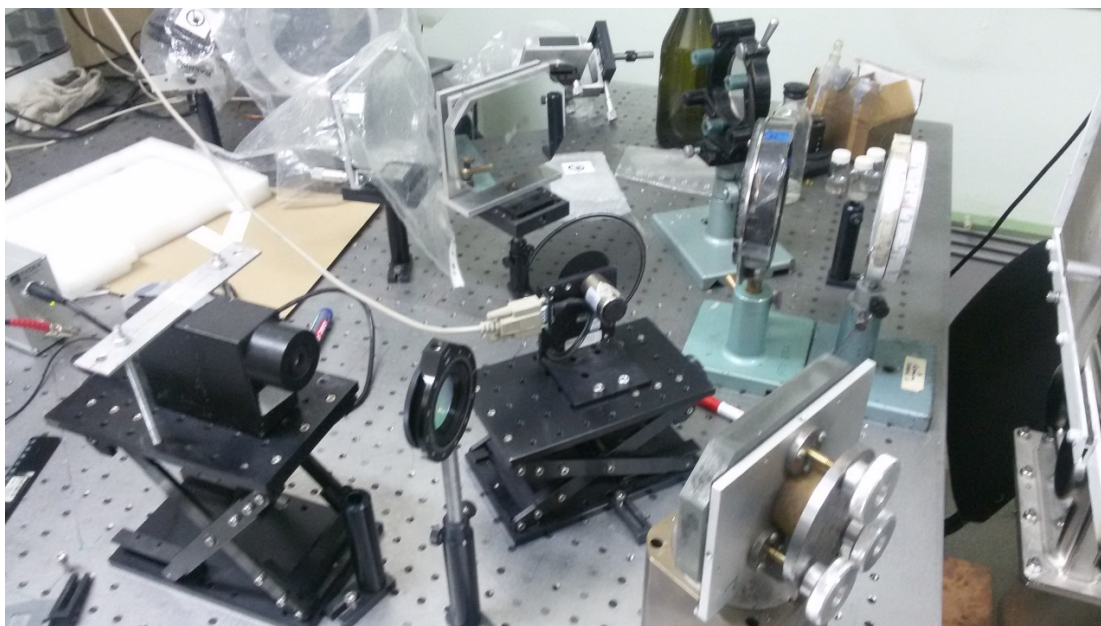
Рисунок 26 – Экспериментальная установка для калибровки поляризаторов и детектора Голея.
