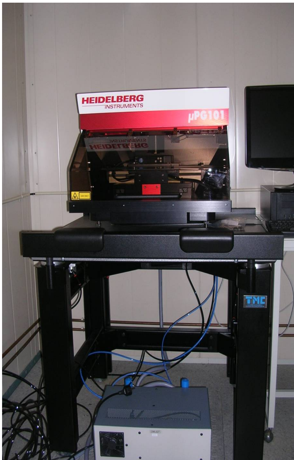
Рисунок 2.7 Установка μPG101 - лазерный генератор изображения, в лаборатории ЦКП ИФМ РАН
