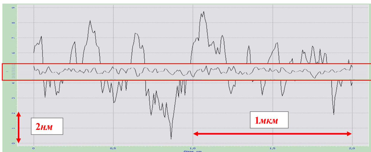
Рисунок 5.6 Профили шероховатости поверхности зеркал объектива до коррекции формы методом ионно-пучкового травления (в рамке) и после травления. Оба графика приведены в одном масштабе.
