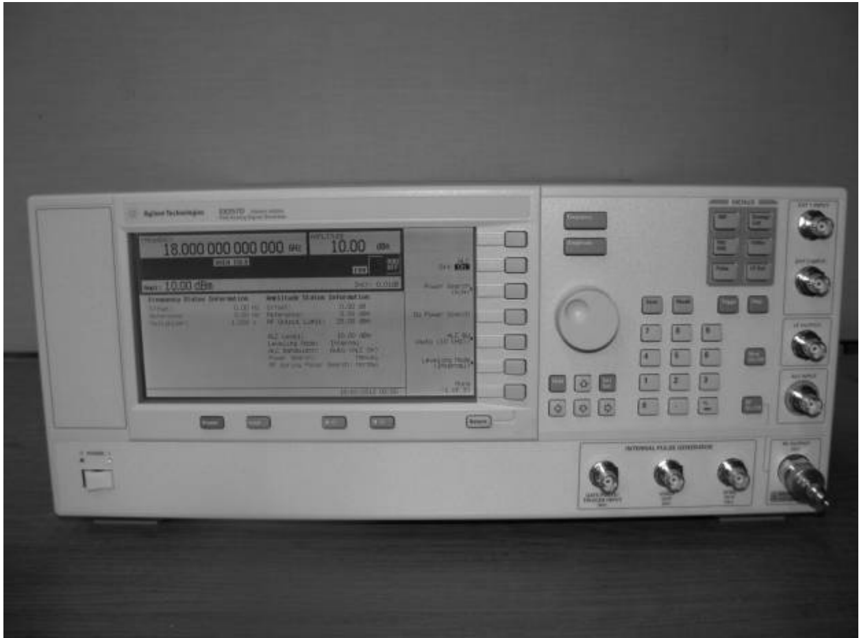
Рисунок 1.7 Генератор сигналов Agilent Technologies E8257D.
