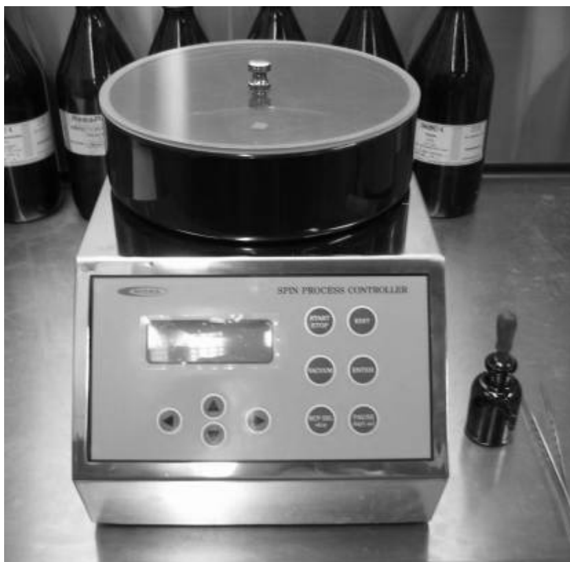
Рисунок 1.16 Общий вид центрифуги для нанесения фоторезиста модели SPIN-1200D производства фирмы MIDAS System Co., Ltd. (Корея)
