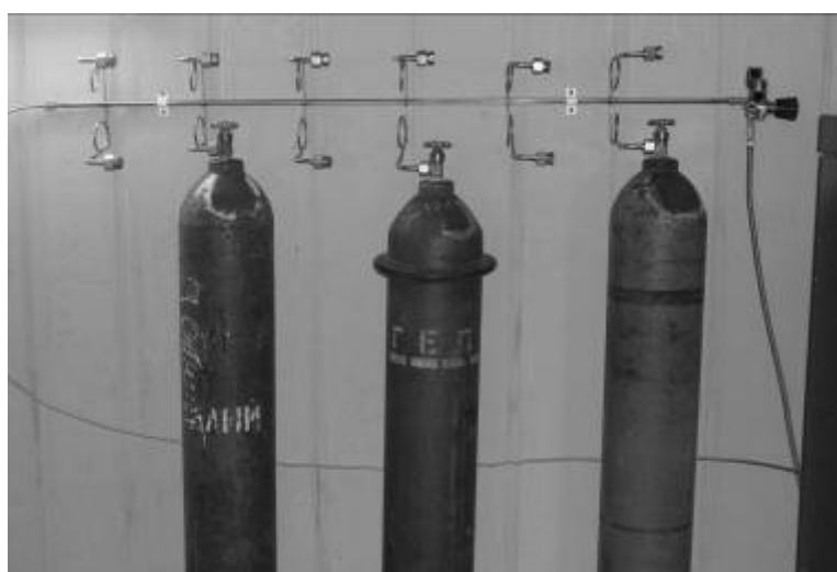
Рисунок 1.11 Рампа с баллонами высокого (до 150 атм.) давления для хранения газообразного гелия.
