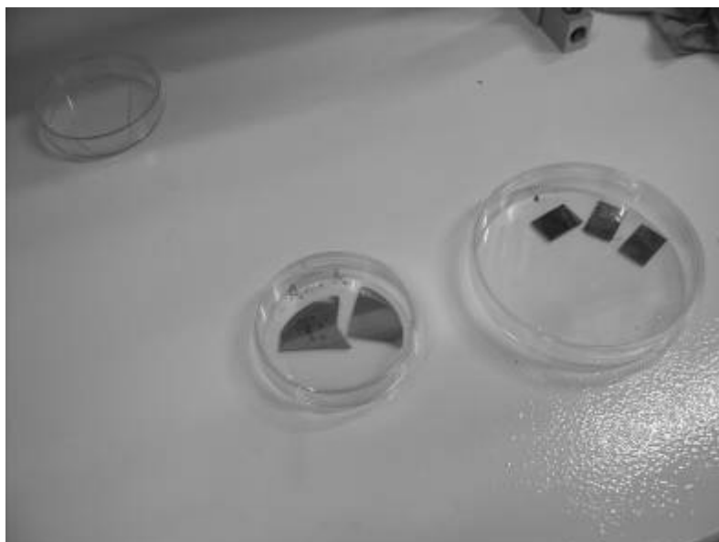
Рисунок 1.2 Образцы металлических пленок, полученные при тестовых испытаниях
