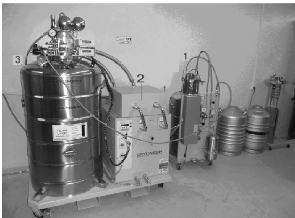
Рисунок 1.9 Установка по ожижению гелия (Cryomech LHeP18) и система очистки газа в лаборатории ЦКП ИФМ РАН. На рисунке: 1-система очистки, 2- компрессор гелиевого ожижителя, 3- сосуд для жидкого гелия.
