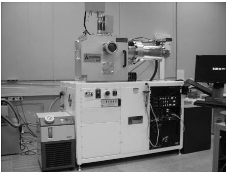
Рисунок 1.1 Установка Amod 206 – вакуумный пост, в лаборатории ЦКП ИФМ РАН
