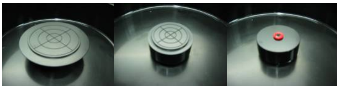
Рисунок 1.17 Комплект вакуумных держателей подложек размером 4 и 2 дюйма и кусков подложек
